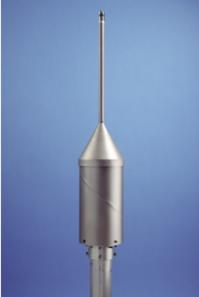
NOWA, vereisungssicheres Anemometer hoher Messleistung, eingesetzt an extremen Standorten in den Alpen.
